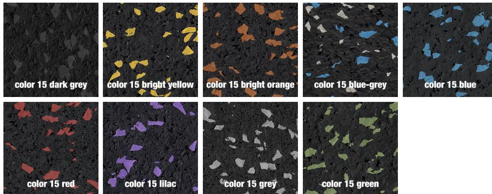
Oberfläche: feine Granulatstruktur mit EPDM-Farbgranulaten
